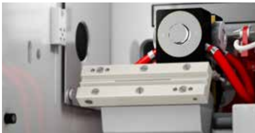
contrAA 800 Dは1つのサンプルコンパートメントでフレイム法とファーネス法の使用ができます。
