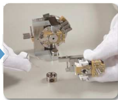
5. イオン源からチャンバーを外し、 洗浄します
